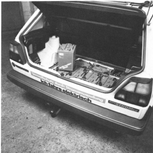
Fig. 16. 96-V 160-Ah Dryfit battery in a VW CityStromer.
